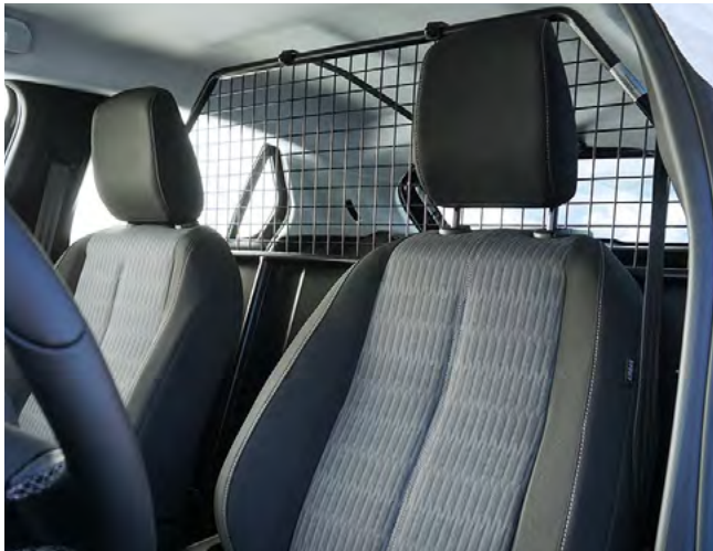
► PRZEGRODA. Wytrzymała krata zabezpieczająca przedział osobowy jednocześnie dająca możliwość pełnego odsunięcia foteli.
