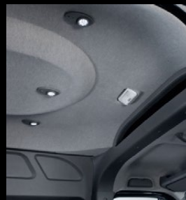
Podsufitka z oświetleniem
